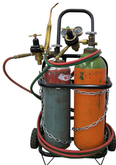
Equipo de oxiacetileno portátil con juego de mangueras, manómetros y boquillas de soldadura:
