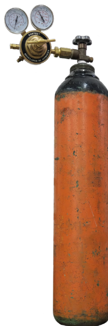
Tanque de nitrógeno portátil de 20 ft 3 con manómetro regulador (referencia normas DOT3AA2015).
